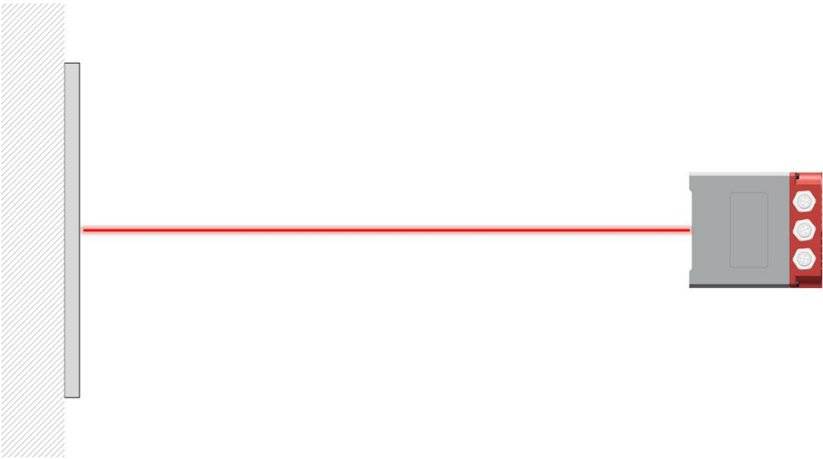
图 4.3: 激光测距传感器及反射板安装示意
