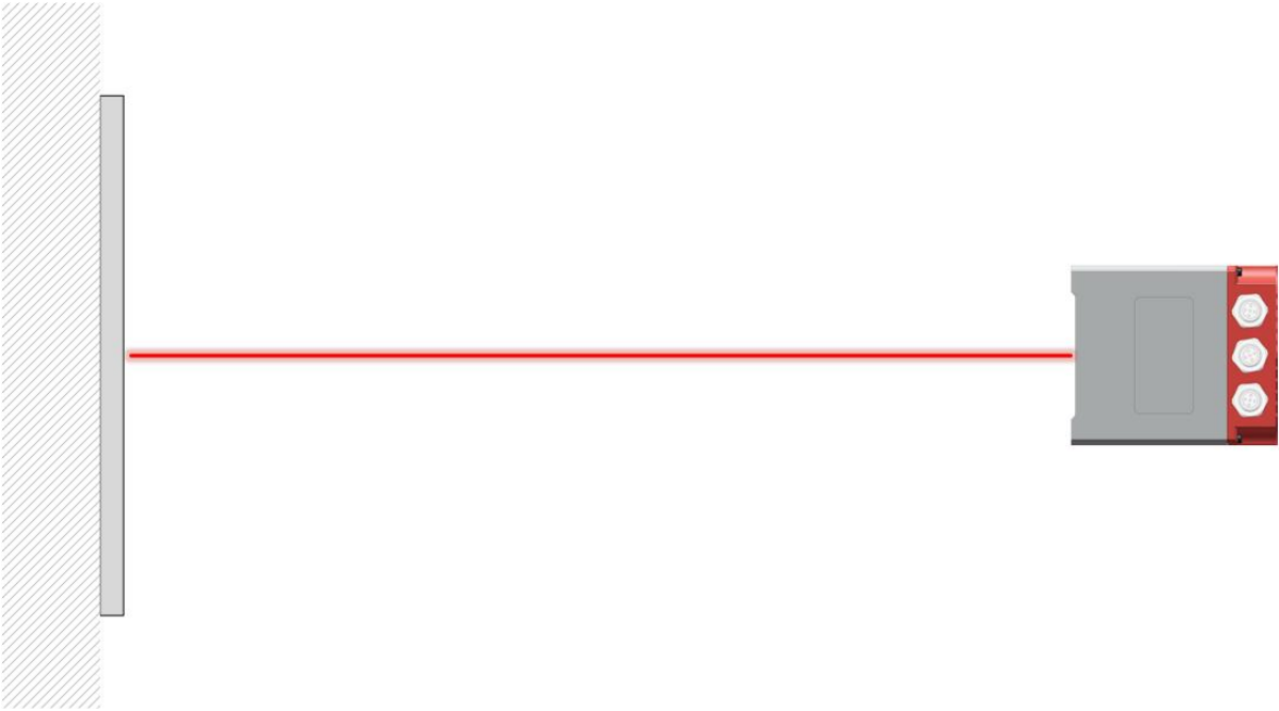
图 4.3: 激光测距传感器及反射板安装示意
