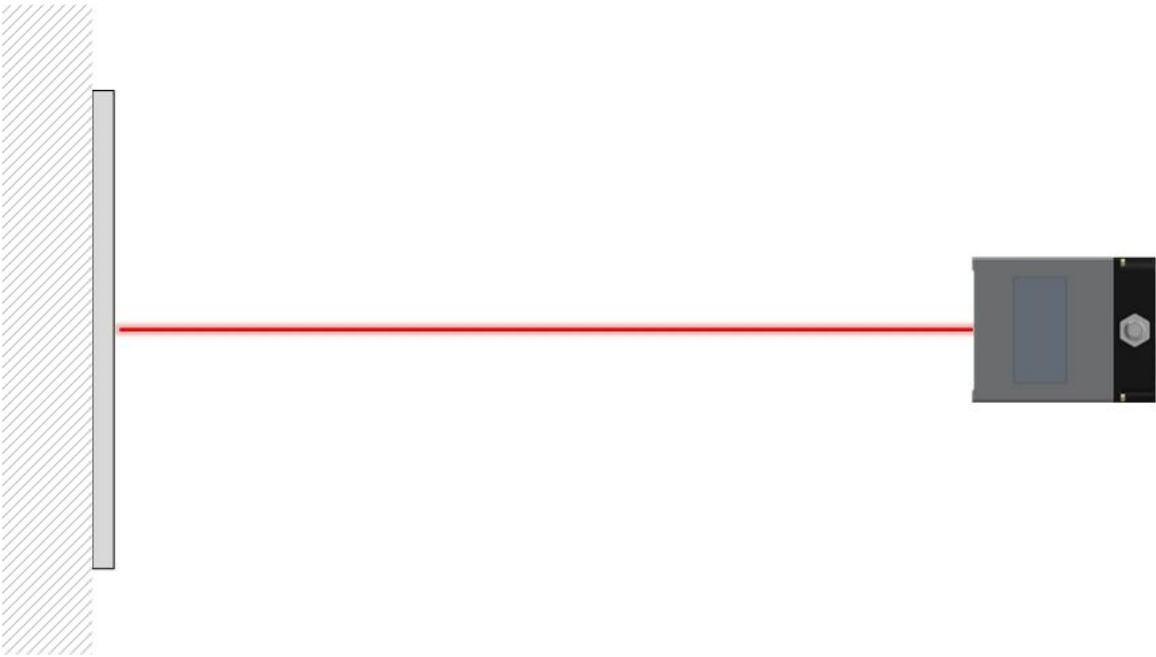
图 4.3: 激光测距传感器及反射板安装示意
