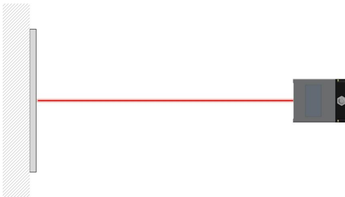
图 4.3: 激光测距传感器及反射板安装示意
