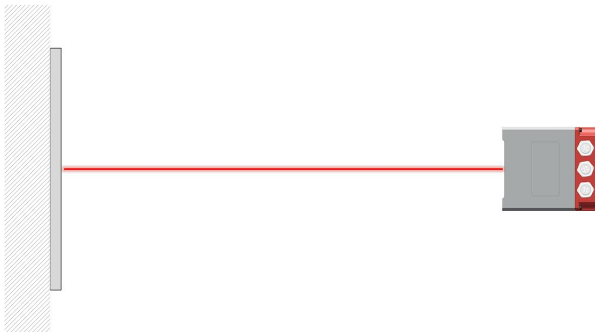
图 4.3: 激光测距传感器及反射板安装示意
