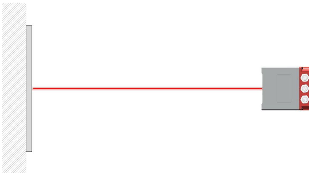
图 4.3: 激光测距传感器及反射板安装示意
