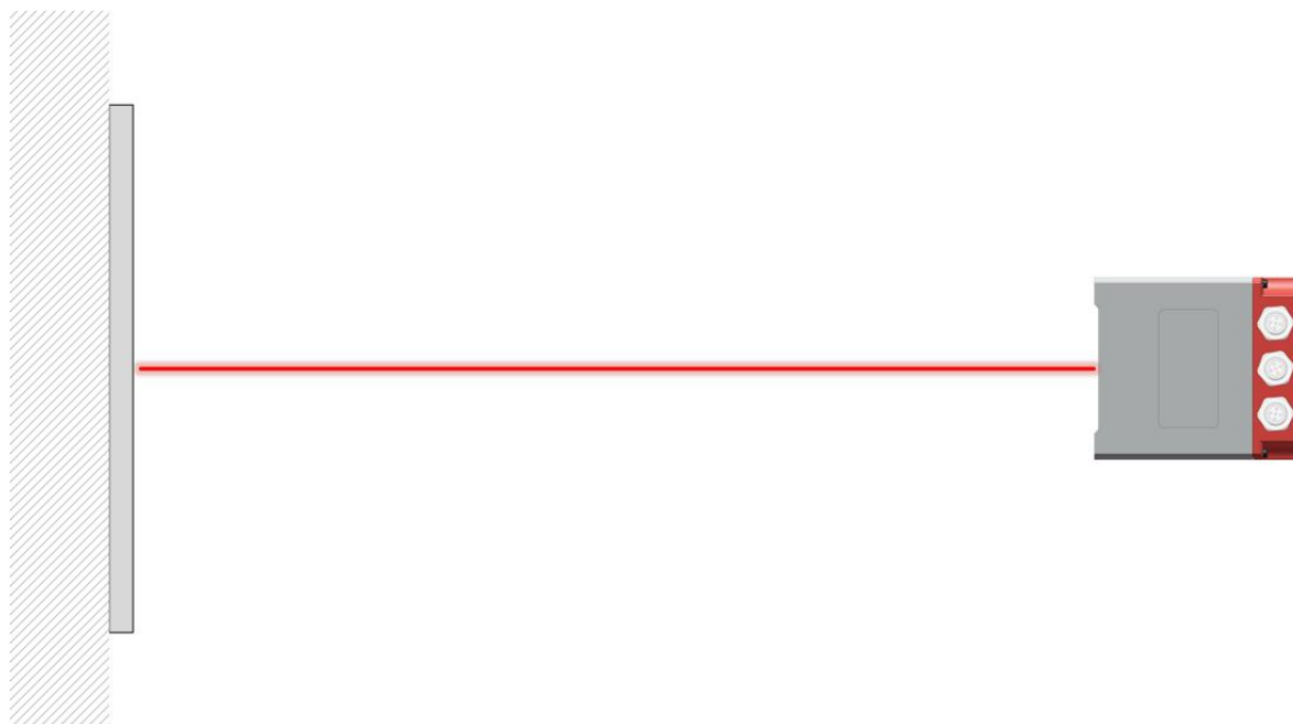
图 4.3: 激光测距传感器及反射板安装示意
